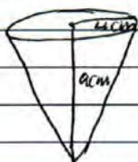
$V_{\text{cone}} = \frac{1}{3} \cdot A_b \cdot h$
